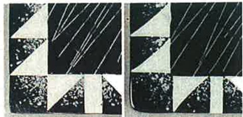
図5: 左のピースはデザイン部を下にして焼成。右はデザイン部を上にして焼成。左の方はラインがはっきりしている。
