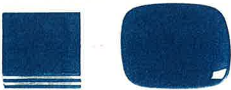
図2: 3mmを5枚重ね816℃で焼成 サイズに注目。ガラスが広がっている。
