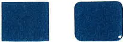
図1: 3mmを2枚重ね816℃で焼成 大きさは特に変わらず。縁もまっすぐ。
