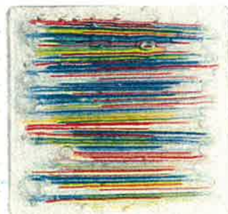
図6: 焼成中縁周りが先に溶け空気の逃げ道をふさぎ、閉じ込めてしまった。
