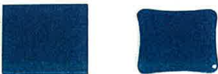
図3: 3mmを1枚で816℃で焼成 縁が内側へ引っ込まれている。
