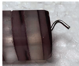
細いプライヤーで先端を少しずつ丸めていきます
